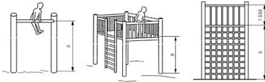
Figura 5. Ejemplos de cómo determinar la altura de caída libre (Fuente SFS-EN1176).
